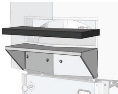
Den Stein aufsetzen und etwas andrücken, damit er korrekt sitzt. Sicherstellen, dass der Winkel im Granit auf den Winkel in der Halterung ausgerichtet ist. Den Klebstoff mehrere Stunde trocknen lassen, bevor Lücken zwischen der Steinplatte und der Metallhalterung mit der Silikonmasse (mitgeliefert) gefüllt werden. Überschüssigen Klebstoff und/oder Silikonkleber entfernen, bevor dieser eintrocknet!
